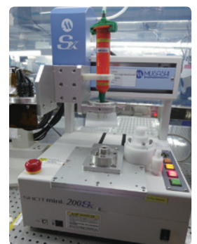
接着剤自動塗布および硬化設備
