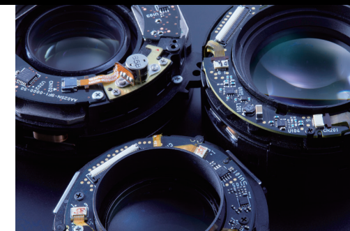
複雑なメカニズムが組み込まれた手ブレ補正機構[VC]ユニット
