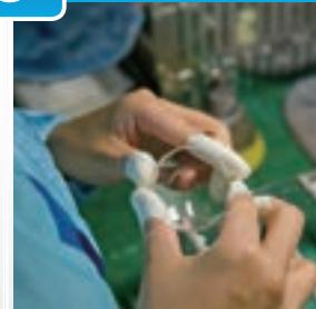
屈折率の異なるレンズ同士を光学用接着剤で貼り合わせ光学性能を向上させる工程。その後、最終検査を経て組立工程へ送られます。
