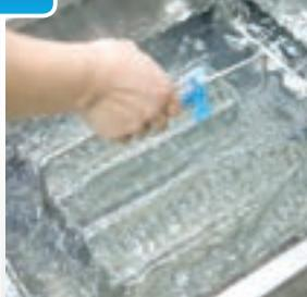
レンズ表面のゴミ、ホコリ、汚れを純水や洗浄薬品で洗い落とす工程。
