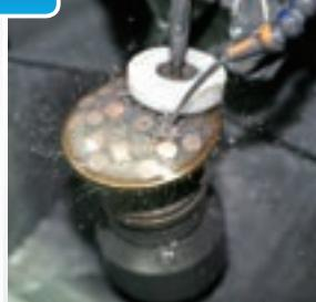
粗ずりされたレンズの球面精度を出す為に、より細かくレンズ表面を磨く工程。ダイヤモンドの砥粒が埋め込まれた皿の上で行われます。摩擦熱が発生するので冷却液で冷却しながら行います。
