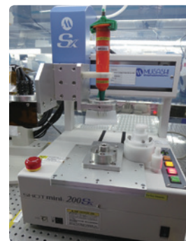
接着剤自動塗布および硬化設備
